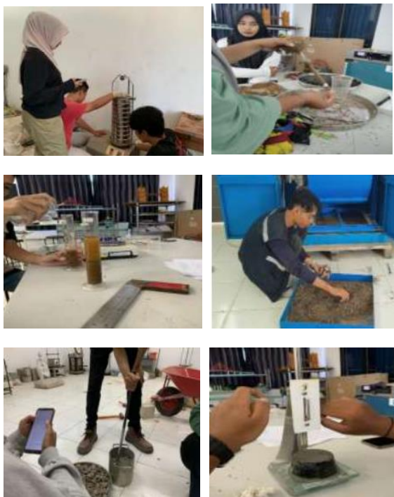
Gambar 2. Pengujian agregat berupa analisa saringan, berat jenis, kadar lumpur, keausan, berat isi, dan semen
