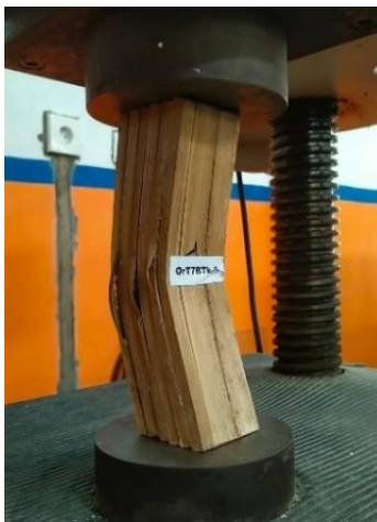
Gambar 7. Mode Kerusakan Tekan Laminasi
