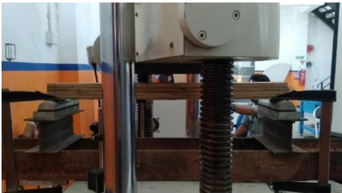
Gambar 10. Benda Uji Lentur pada Alat UTM
