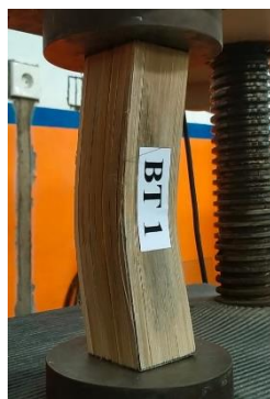
Gambar 7. Kerusakan Balok Laminasi Uji Tekan
