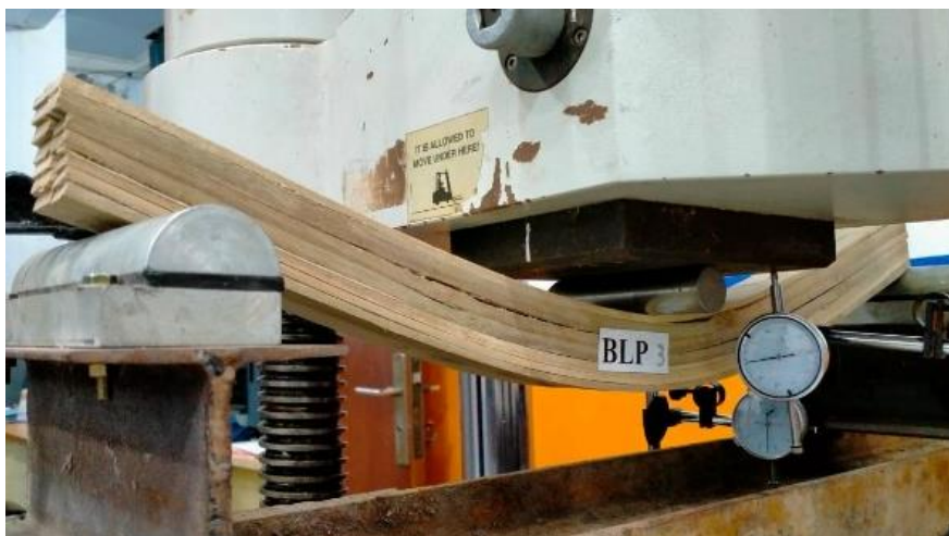
Gambar 13. Kerusakan Retak Mendatar
