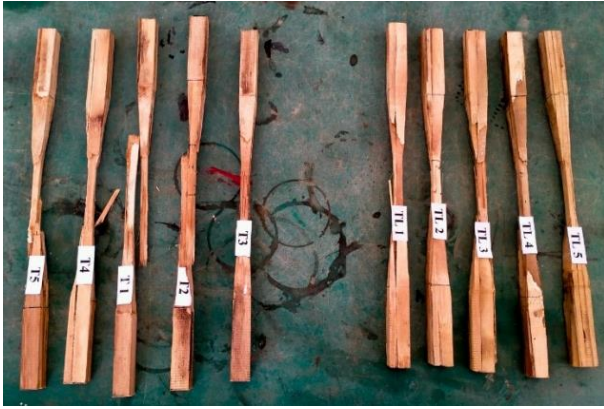
Gambar 10. Kerusakan Balok Laminasi Uji Tarik
