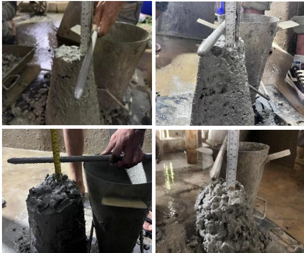
Gambar 2. Pengukuran konsistensi pada campuran segar tanpa superplasticizer dan dengan penambahan superplasticizer
