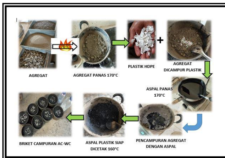
Gambar 1. Proses Pencampuran Benda Uji Beraspal Panas Menggunakan Limbah Plastik
