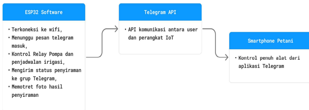
Gambar 2 Arsitektur Software Sistem Irigasi IoT
